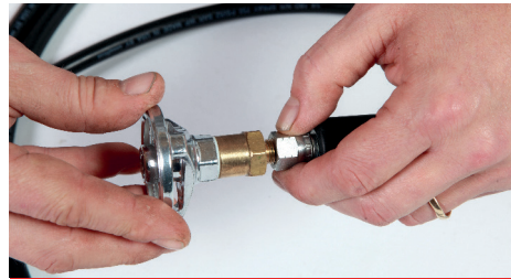
4. Sluit de Cleaning Adaptor aan op de materiaalslang en draai deze vast
