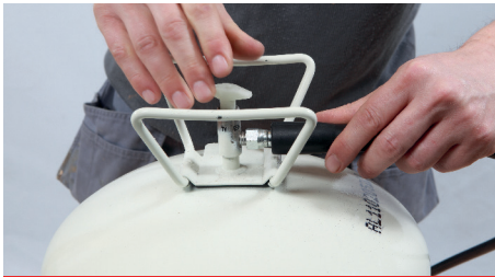
3. Koppel de materiaalslang los van de canister
