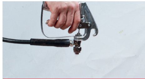
2. Spuit de materiaalslang volledig leeg tot er geen lijm en drijfgas meer uitkomt
